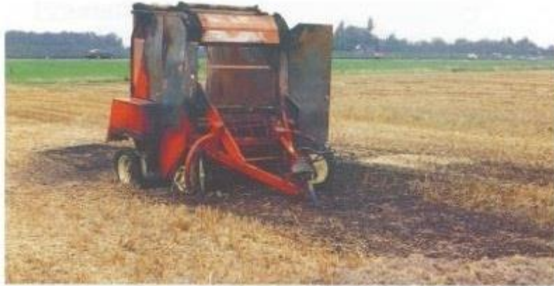
Hatalı kullanım nedeniyle yanmış bir yuvarlak balya makinesi
